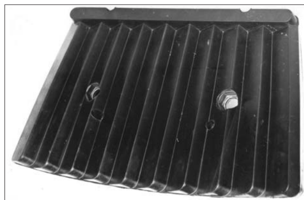
Рис. 5. Сектор футеровки с ребристой рабочей поверхностью
