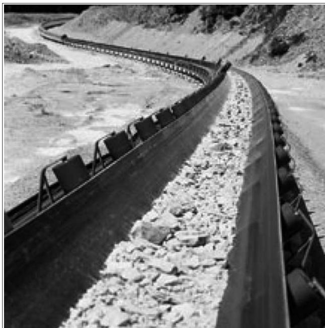
Рис. 1. Криволинейный участок ленточного конвейера для транспортировки известняка
